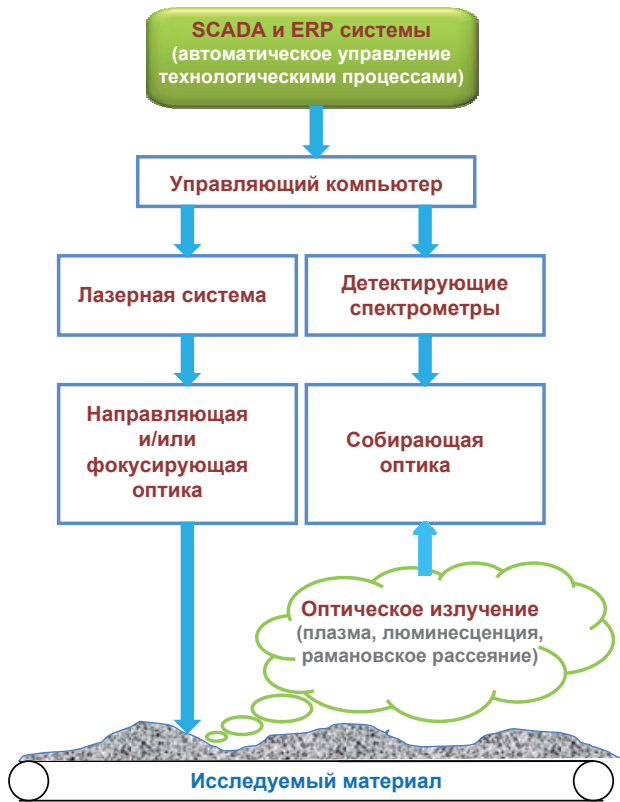
Рис. 4. Принципиальная схема работы лазерного анализатора МАУА
