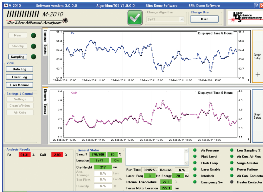
Рис. 2. Интерфейс динамики изменения содержания Fe и CaO в железорудной смеси. Вид системы МАУА
